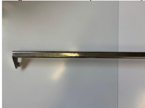
Figura 3 - Régua de cremalheira para estruturação vertical
